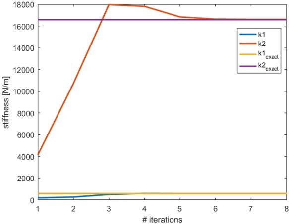
Fig. 3: Stiffness parameters per iteration
